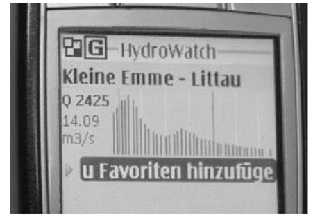
Abb. 5. Hydrowatch - Online Datenabfrage und grafische Anzeige von bis zu 50 Werten auf javafähigen Mobiltelefonen.
