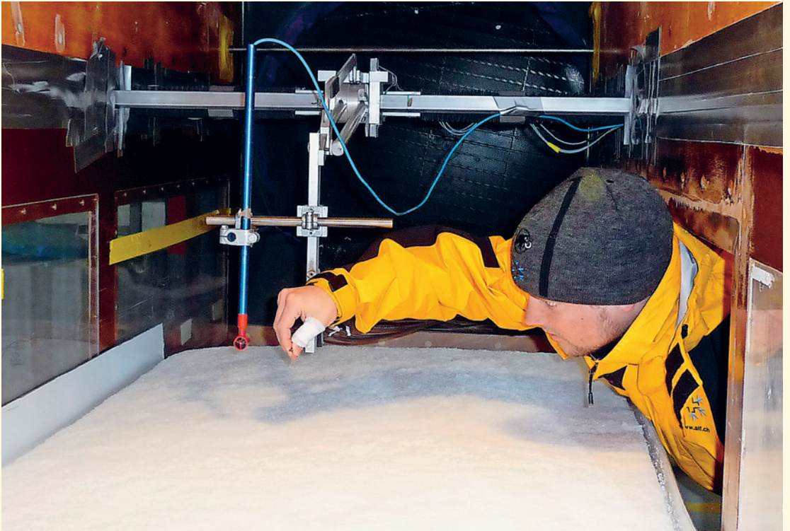
Im Windkanal des SLF untersuchen Forschende die Verfrachtung von Schnee.
