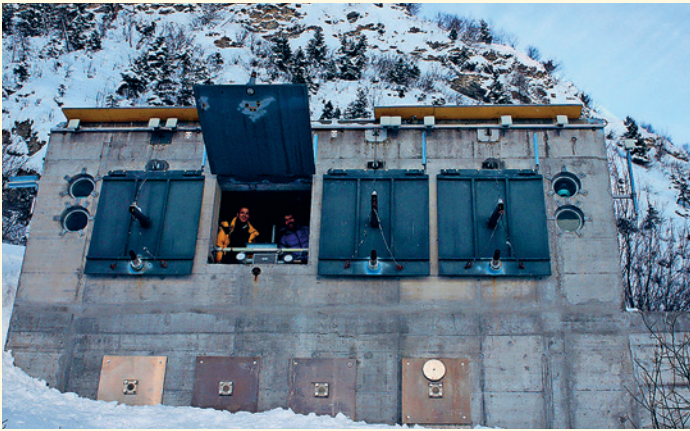
Mit einem Radar untersuchen Forschende vom Beobachtungsbunker aus das Fliessverhalten von Lawinen.
