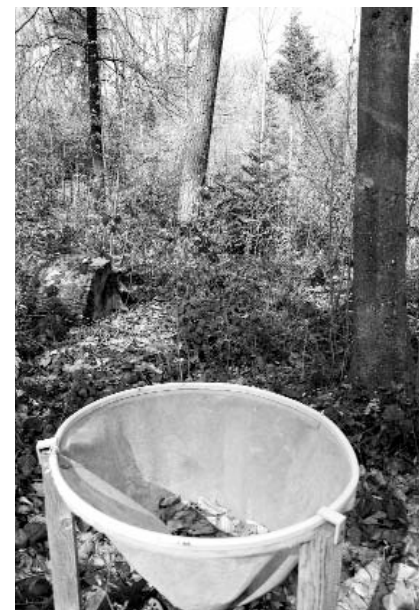
Abb. 4: Streusammler auf einer Fläche der Langfristigen Waldökosystem-Forschung der WSL. Wissenschaftler analysieren später im Labor die Menge und Zusammensetzung der Nährstoffe in den Blättern und Nadeln. Foto: Reinhard Lässig
