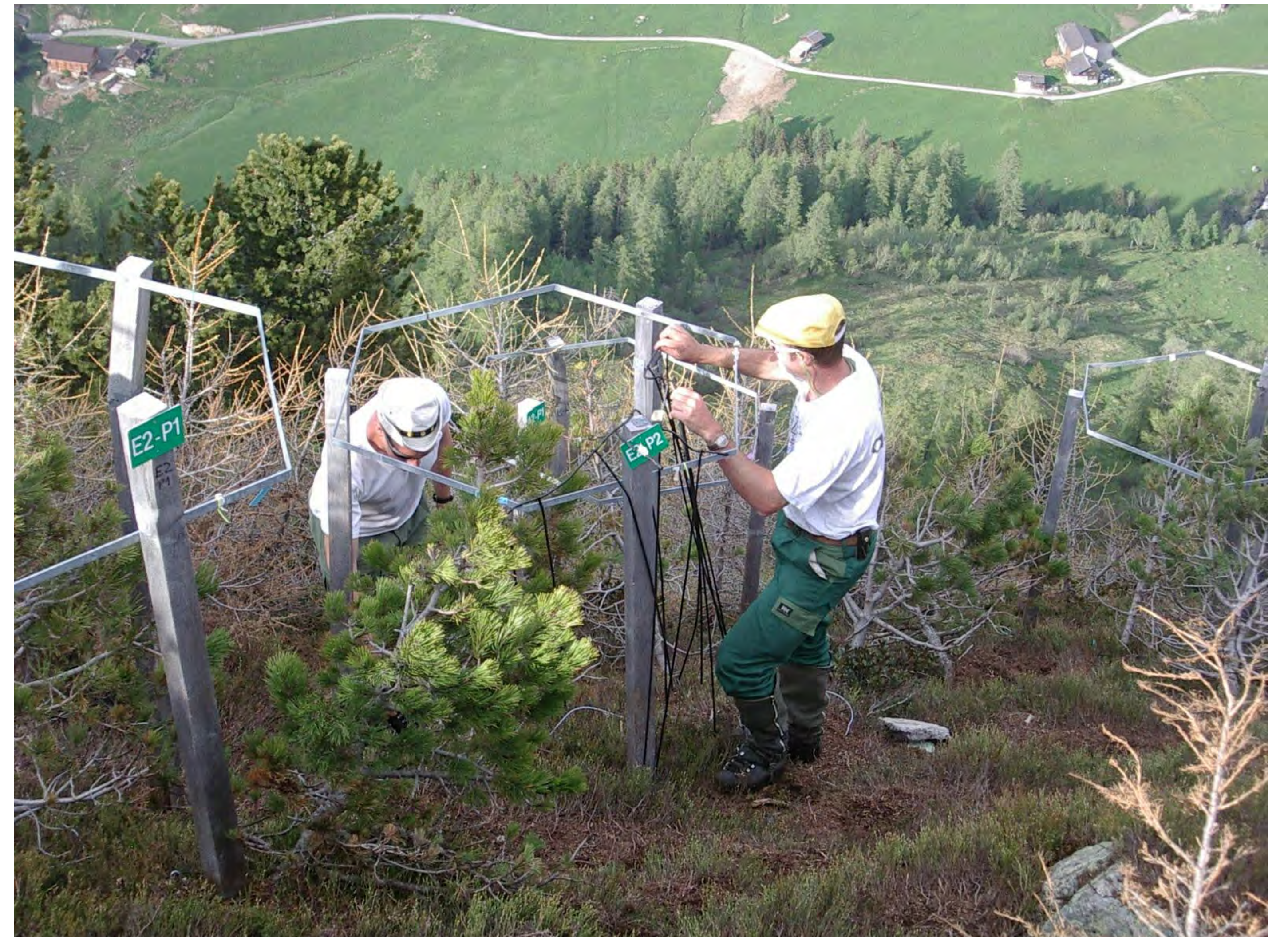
Abb. 1: Installation von perforierten Schläuchen zur gezielten CO 2 -Begasung (Foto: F. Hagedorn, WSL)
