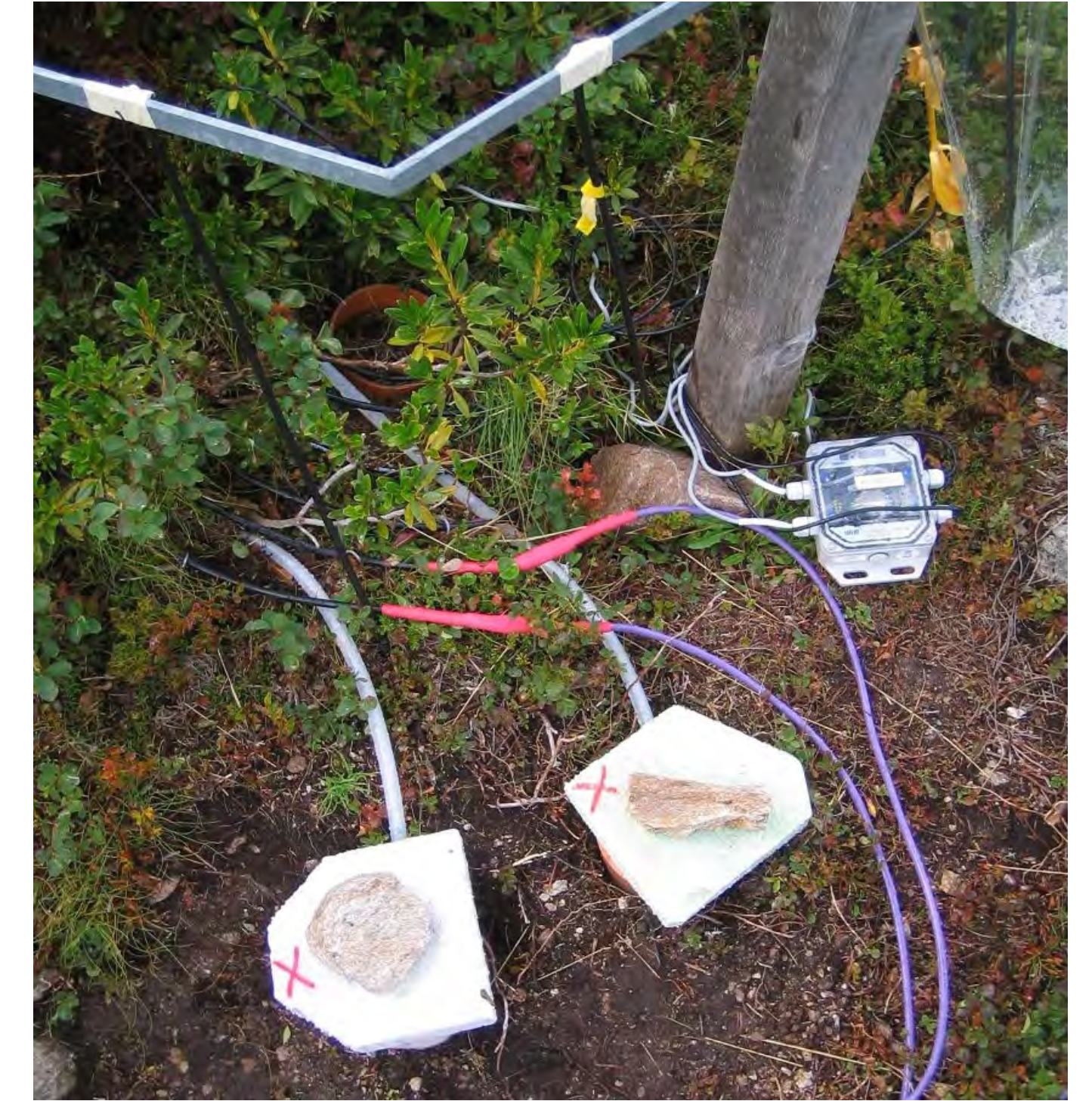
Erwärmung des Bodens um 4° C mit 26 m Heizkabeln auf 1.1 m².
