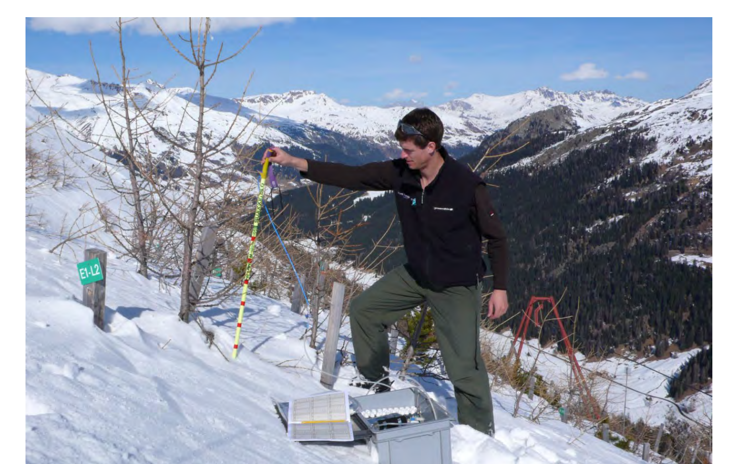
Messung der CO 2 -Freisetzung aus dem Boden im Sommer und Winter.
