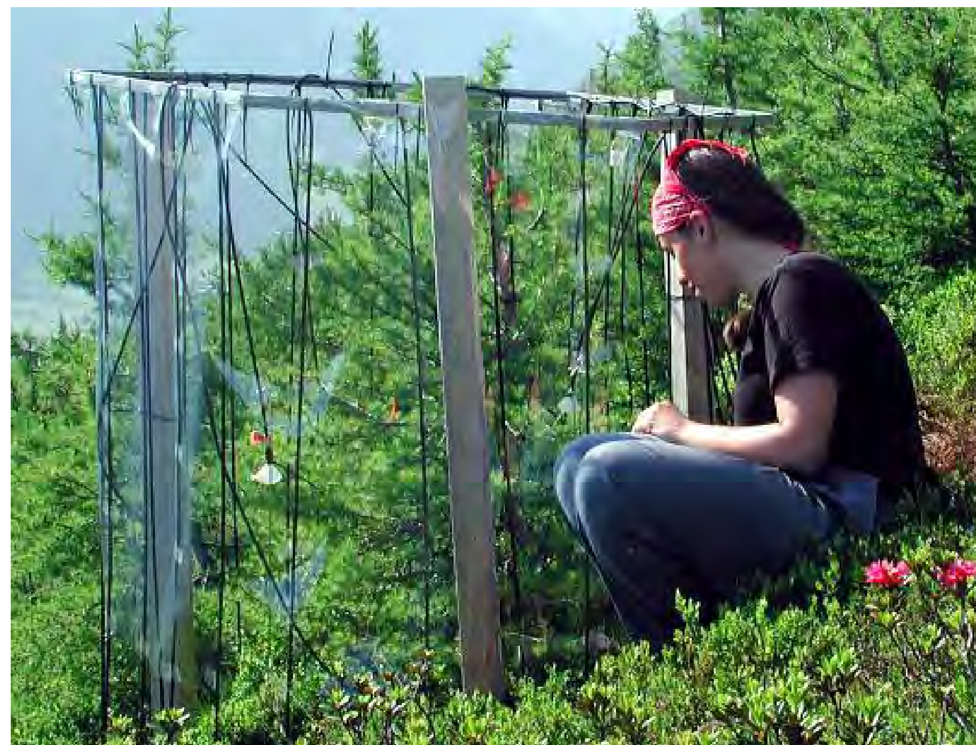
Kontinuierliche CO 2 -Erhöhung mit perforierten Schläuchen für 9 Jahre
