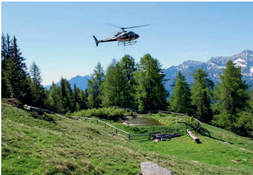
Abb 5 Prüfung der Zweckmässigkeit und der Funktionalität eines Helikopter-Löschwasserbeckens. Foto: Corpo Pompieri Faido
