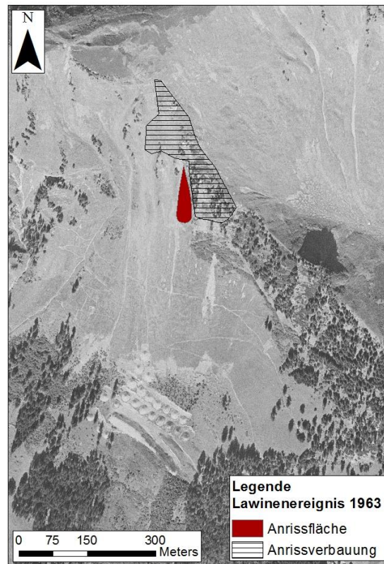
Abbildung 25: Definierte Anrissfläche (rot) des Lawineneignisses von 1963, die schwarzgestrichelte Fläche zeigt die Ausdehnung der Anrissverbauung im Jahr 1963.
