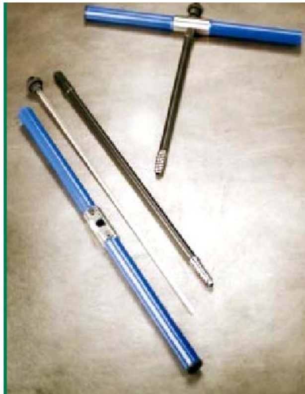
Abb. 3.4.1.: Zuwachsbohrer der Firma Suunto mit den Einzelteilen, von unten: Griffrohr mit Schloss, Bohrkernlöffel und Bohrer. Darüber: Bohrer und Griffrohr zusammengesetzt.
