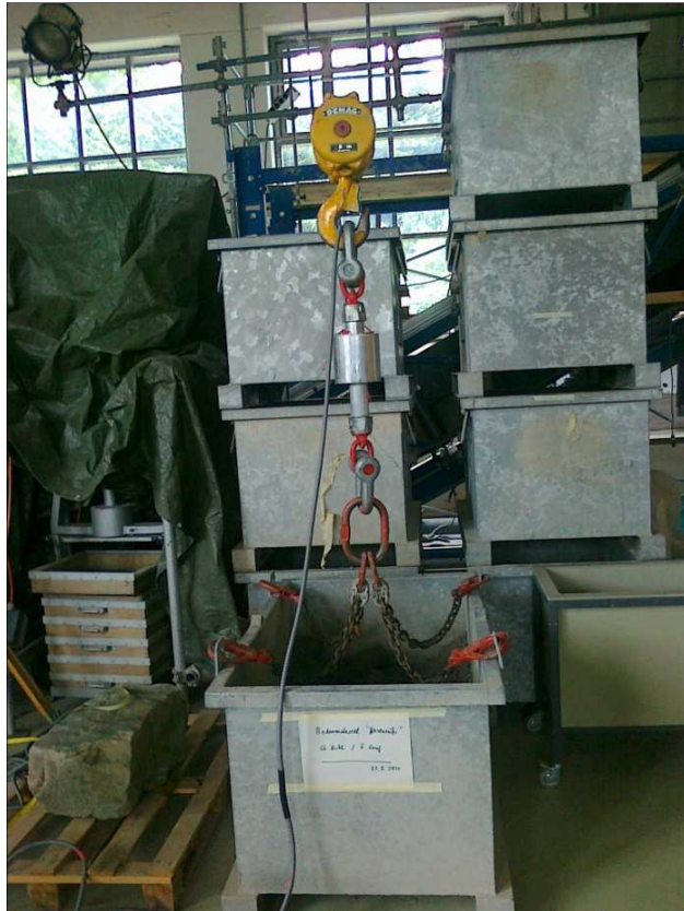
Fig. 10 : Essai du matériel dans la halle d'expérimentation du WSL, Birmensdorf. Ici, un bac de béton de 500 Kg est levé à l'aide d'un palan, permettant ainsi la calibration de l'appareil de mesure situé entre le bac et l'élévateur.
