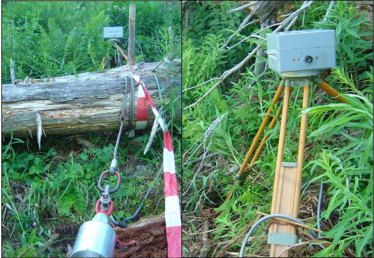
Fig. 11 : A gauche, l'installation de traction des troncs. Au premier plan (aval du tronc testé) se trouve le câble de traction et l'appareil de mesure de la force. A l'arrière plan (amont du tronc) et sur la photo de droite, on distingue le boîtier de mesure du déplacement, placé sur son trépied et relié au tronc par la ficelle et le fil nylon.
