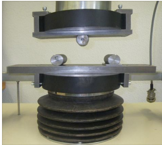
Abbildung 10: Prüfmaschine mit oberem und unterem Druckkolben und der Auflagervorrichtung. Bewegliches Auflager links und festes Auflager rechts.
