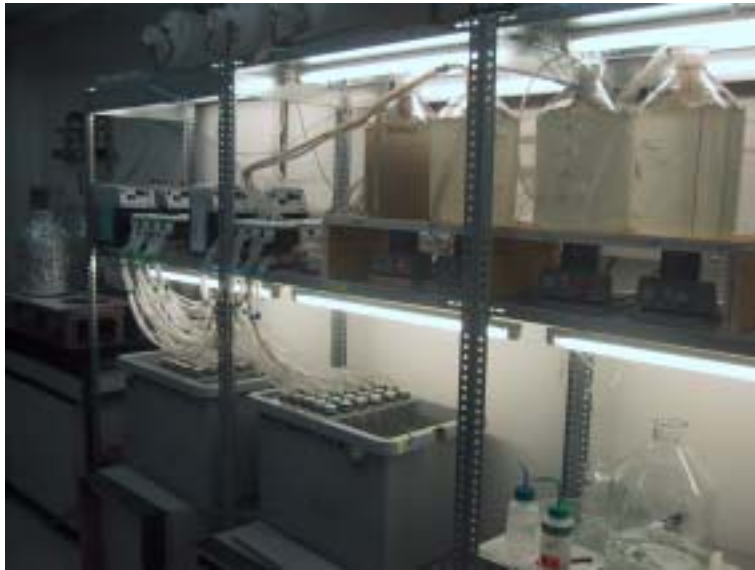
Abbildung 22: Durchflussversuch zur Bestimmung des Einflusses von Schwebstoffen auf die Fitness von Daphnien. Oben rechts: Medien mit verschiedenen Schwebstoffkonzentrationen. Ganz links: Medien mit verschiedenen Algenkonzentrationen. Oben Mitte: Durchfluspumpen. Unten: Experimentelle Einheiten (Foto: Christian Rellstab).
