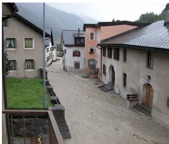
Abb. 3: Bei Hochwasser werden meist nur die unteren Stockwerke und der Keller betroffen. Dies ist bei der Beurteilung der Schadenempfindlichkeit von Gebäuden zu berücksichtigen (Foto: O. Korup, SLF).
