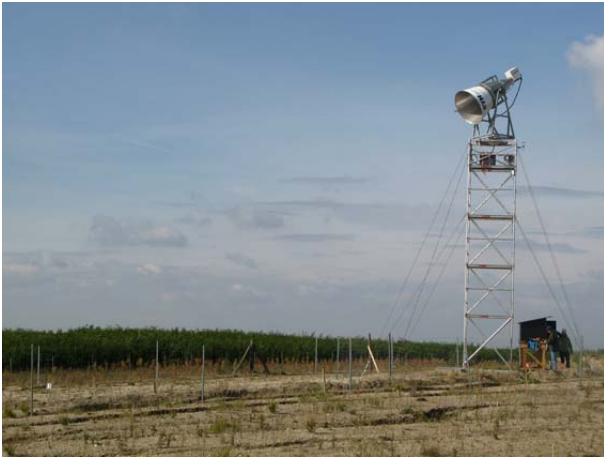
Abb. 1: Bodenfeuchtemessungen mittels Mikrowellen-Radiometrie in Cottbus (Foto: WSL).
