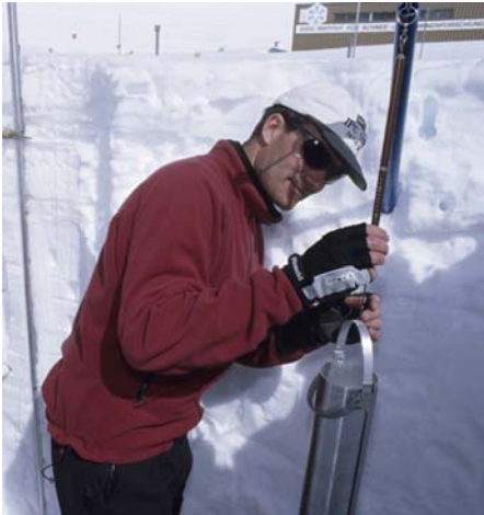
Abb. 1: Messung des Schneewasseräquivalents im Versuchsfeld auf dem Weissfluhjoch (2540m) oberhalb Davos (Foto: Ammon (AURA)).
