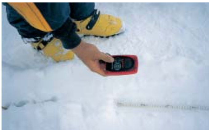
Bestimmung der maximalen optischen Reichweite mit einem Mammut Barryvox als Empfänger
