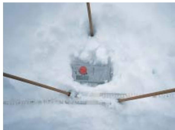
Ein Ortovox M2 als Sender bei der Bestimmung der maximalen Reichweite durch Annähern in koaxialer Position
