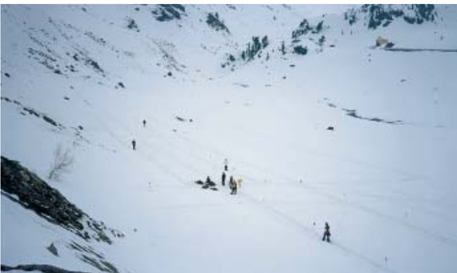
Bestimmung der mittleren Reichweite durch Vorbeigehen an einem beliebig orientierten Sender. Die Suchenden bewegen sich auf parallelen Suchlinien im Abstand von 5, 10, 15 und 20 m vom Sender.
