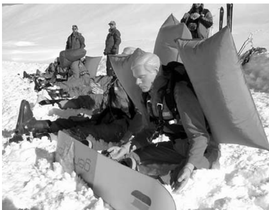
Abb. 2: Versuchspuppe mit Doppellairbag: Vorbereitungen für den Feldversuch Pischs-Wäng vom 16. März 2001 (Kern et al., 2001).
