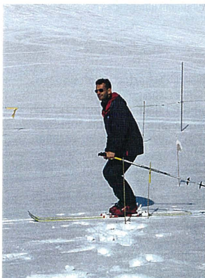
Stehen, Wippen und Springen: Ein Skifahrer (oder auch einmal ein Snowboarder) steht, wippt oder springt – ähnlich wie bei einem Rutschblockversuch – genau oberhalb der Messapparatur auf die Schneedecke.
