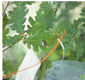
Exemple d'un capteur de pression, mesurant les variations d'épaisseur d'une feuille de chêne
