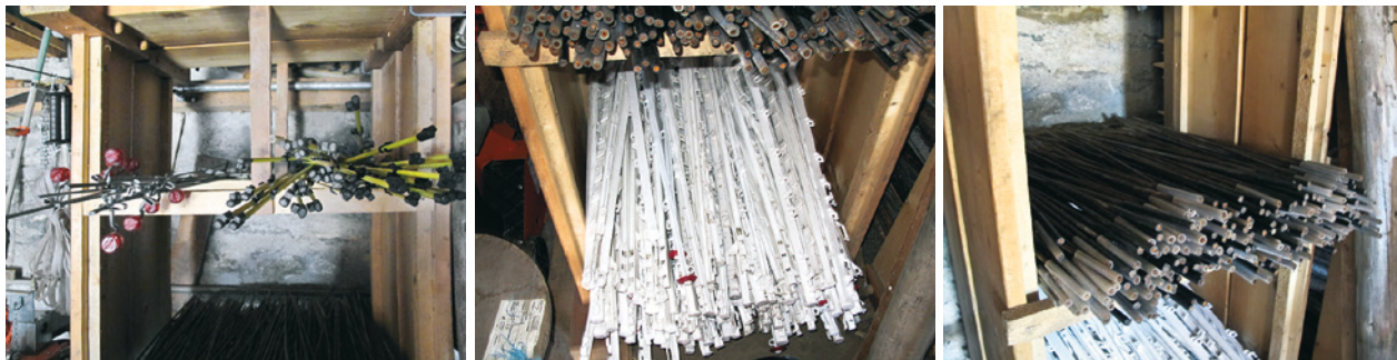
8.7 Systèmes de piquets pour clôtures mobiles, qui se tordent facilement (deux photos de gauche), et piquets de fabrication artisanale, qui évitent ce problème (à droite).
