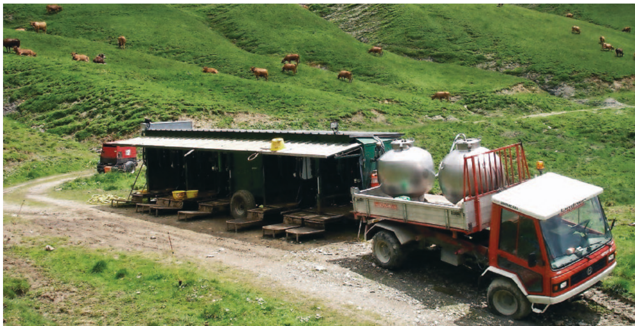
8.2 Salle de traite mobile sur l'alpage français Plan Pichu.
