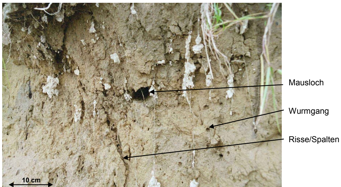
Abbildung 4.19: Makroporen: Wurmgänge, Wurzelkanäle, Risse/Spalten und Mausgänge.
