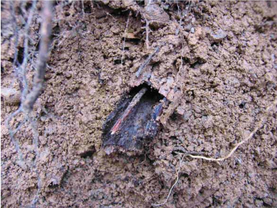
Abbildung 4.23: Makroporen: abgestorbene und vermodernde Wurzeln bilden vordefinierte Fliesswege mit grosser Wasser-Leitfähigkeit.
