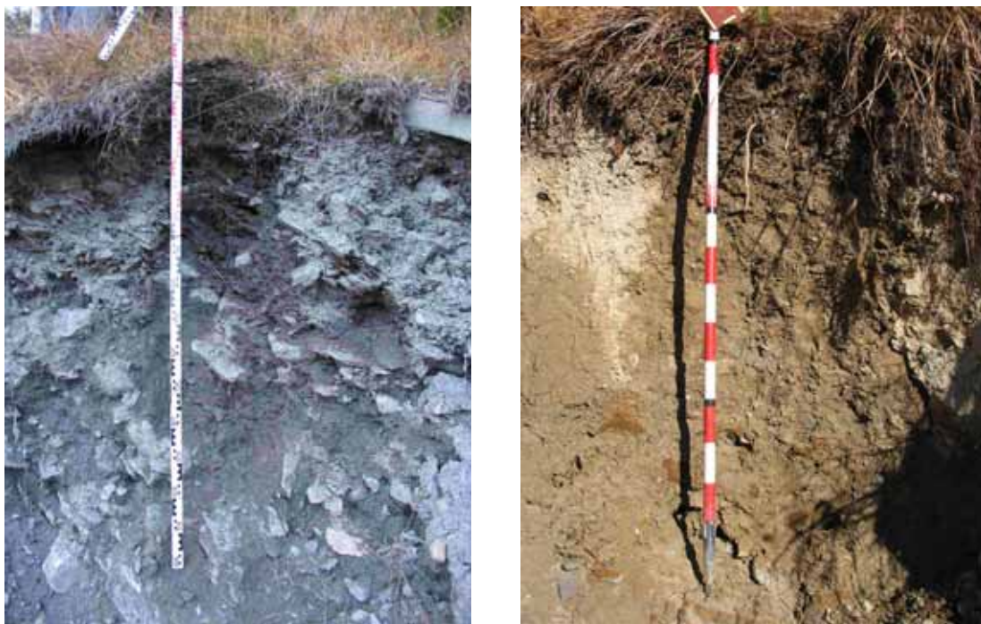
Abbildung 5.6: Bodenprofil mit grobkörnigem Lockergestein (links) und mit feinkörnigem Lockergestein auf Bodenhorizont mit zusätzlich eingeschränkter Durchlässigkeit (rechts).
