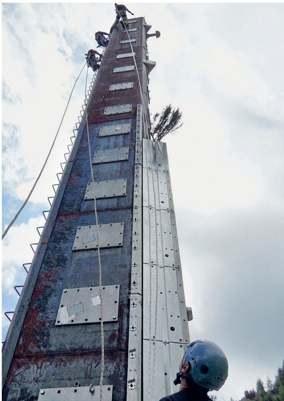
Un mât de mesure de 19 mètres de hauteur se dresse au milieu de la trajectoire des avalanches dans la Vallée de la Sionne. Il est équipé de nombreux instruments de mesure qui déterminent la vitesse, la pression, la densité et la température des avalanches.
