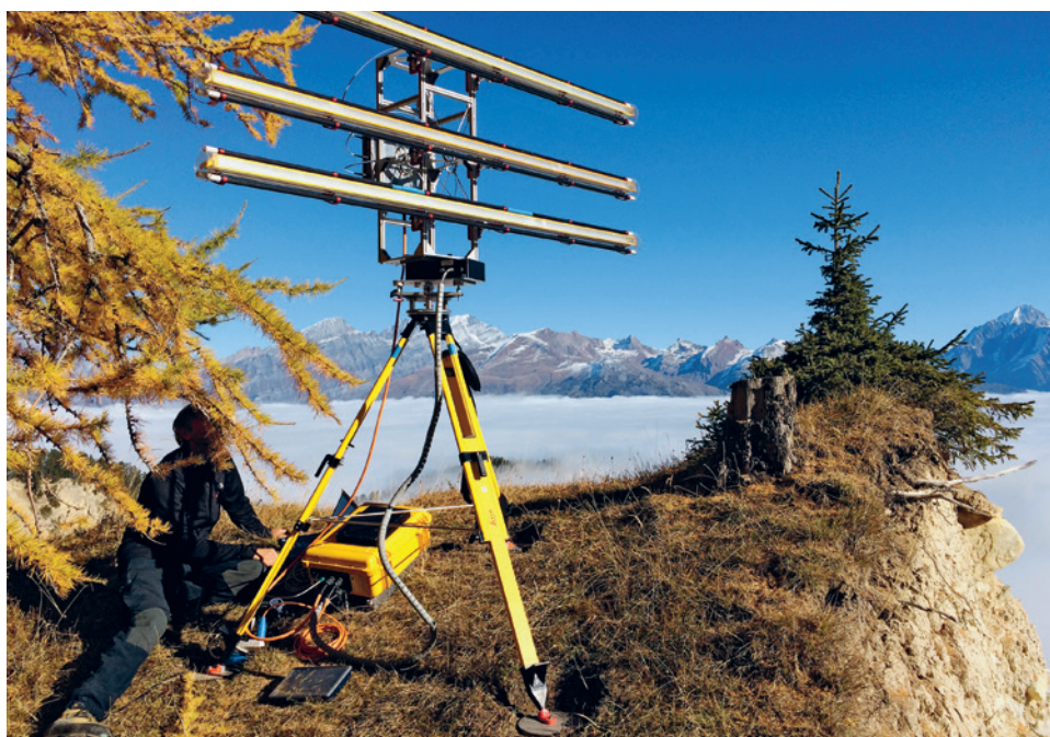
Au-dessus de l'Illgraben, un radar mesure les mouvements des glissements de terrain dans le périmètre observé. Ces glissements de terrain fournissent le matériau dont sont composées les laves torrentielles.
