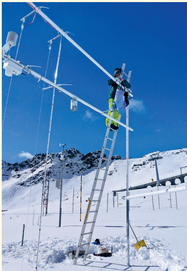
Un chercheur examine un capteur GPS installé sur un mât du site expérimental du Weissfluhjoch près de Davos.
