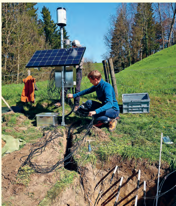
Installation d'une station de mesures de l'humidité du sol près de Ranflüh (BE): des chercheurs connectent les capteurs insérés dans le profil du sol à l'enregistreur de données.
