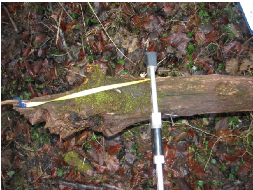
Abbildung 7. Messung des maximalen Durchmessers in Stammfuß- oder Bruchnähe. Die Messung erfolgt dort, wo die Einflüsse durch Wurzelanläufe, Deformationen, fortgeschrittenen Abbau oder Bruch am geringsten sind. Für die Längenmessung wird aber trotzdem ganz aussen angesetzt.
