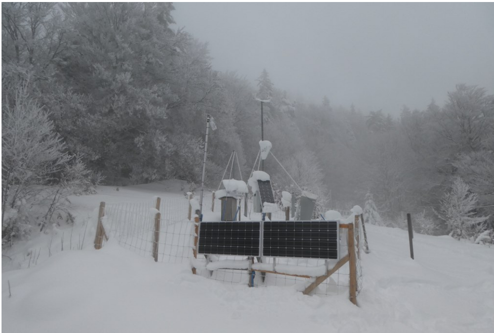
Abb. 3: LWF Meteostation im Winter mit teils schneebedeckten Solarpanels.
