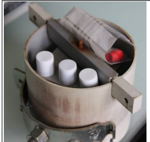
Abb 3. Passiv Ozonsammler in der Halterung (Deckel aufgeschraubt)
