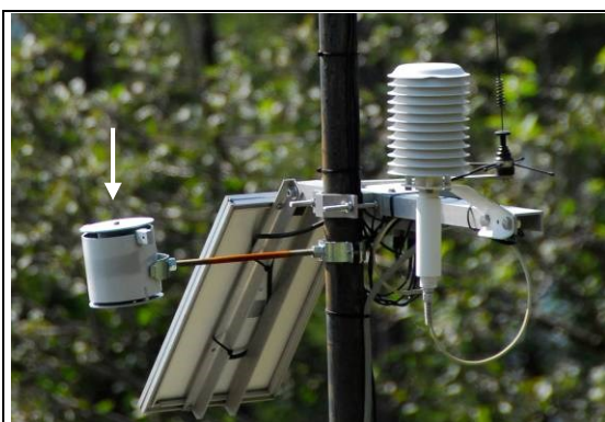
Figure 1. Boîte cylindrique de protection (indiquée par la flèche blanche) fixée au mât de la station météorologique hors couvert
