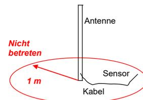
3. Die Stangen enthalten Antennen mit welchen die Daten per Funk zur Übertragungsstation (Gateway) und von über GPRS/GSM dort zu den Servern von EnvEve (Marco Brini) übertragen.
