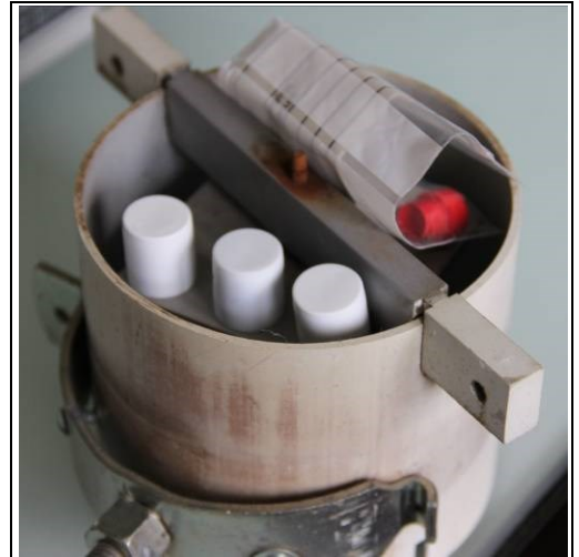
Figure 3. Capteurs passifs d'ozone installés dans la boîte cylindrique (couvercle ouvert)
