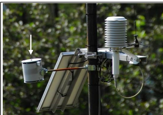
Abb 1. Halterung (siehe Pfeil), am Mast der Meteostation im Freiland montiert
