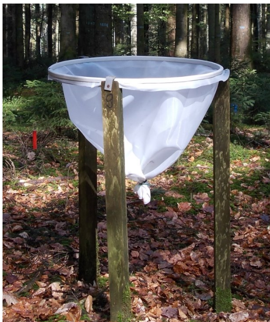
Fig. 1: Streusammler (Auffangfläche 0.25 m 2 )
