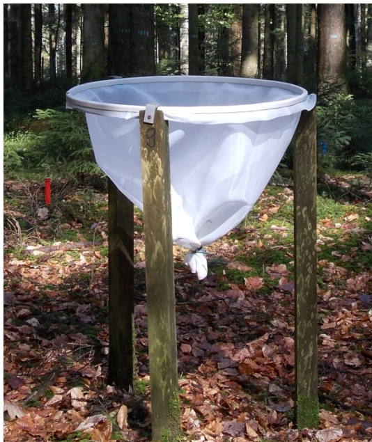
Fig. 1: Streusammler (Auffangfläche 0.25 m 2 )
