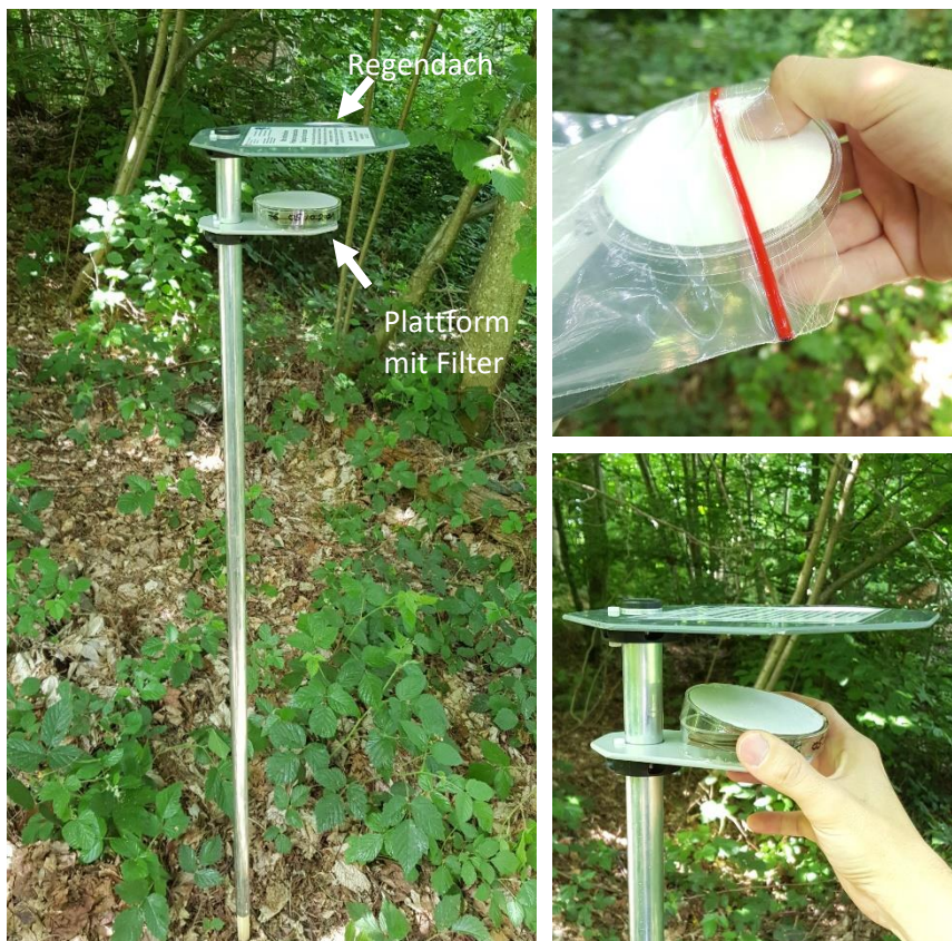
Abbildung: Sporenfalle (Höhe 1.3 m). Rechts: Installation eines Filters (weiss). Ein durchsichtiger Schutzdeckel verhindert während Installation und Transport Kontaminationen.
