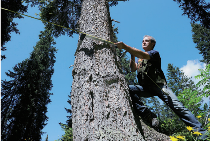
Feldmitarbeiter beim Messen des Brusthöhendurchmessers eines Probebaumes.
