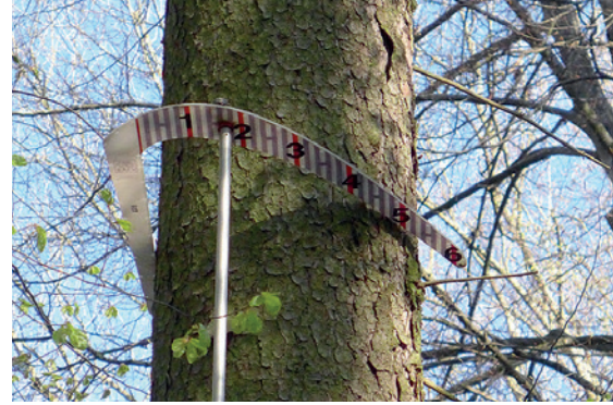
Mit der Finnenkluppe wird der Durchmesser in 7 m Höhe gemessen.
