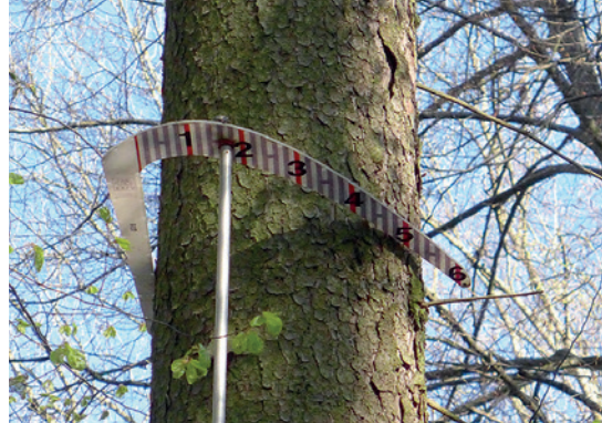
Con un apposito calibro finlandese si misura il diametro degli alberi a 7 metri di altezza.
