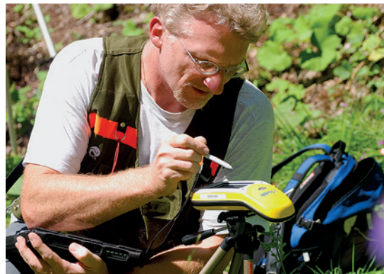
Le coordinate del centro di ogni area di saggio sono misurate con un GPS.
