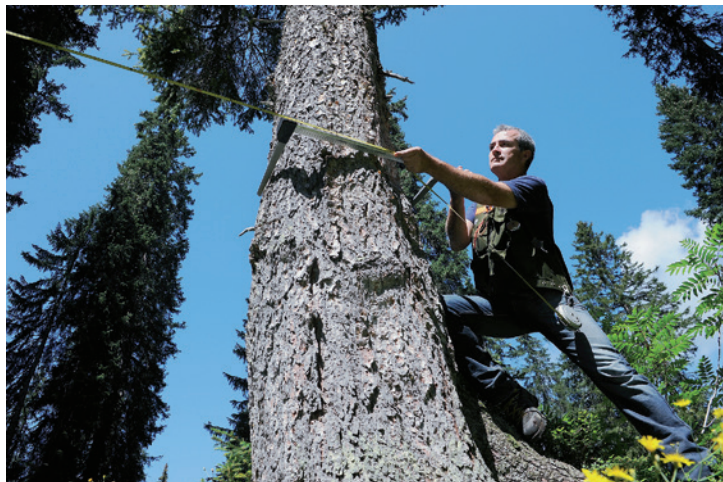
Collaboratore mentre misura il diametro a petto d'uomo di un albero campione.
