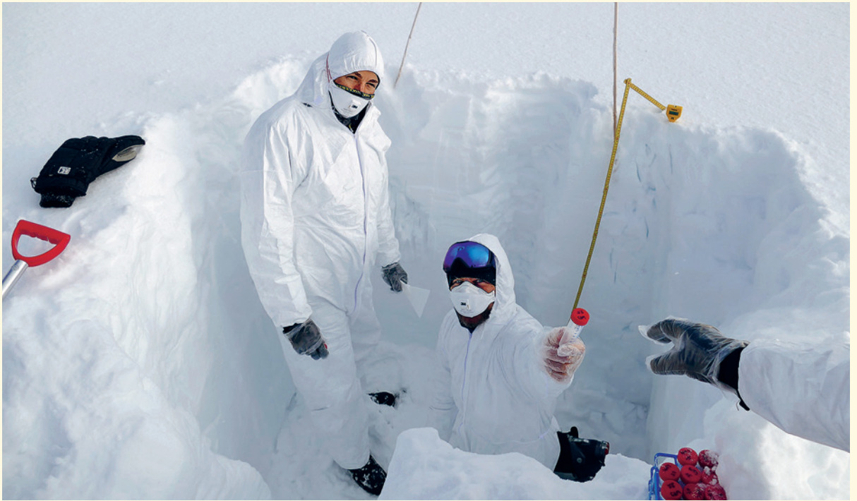
Probenentnahme auf dem Versuchsfeld Weissfluhjoch oberhalb von Davos: Um eine Verunreinigung der Schneeproben zu vermeiden, tragen die Forschenden Schutzanzüge und Mundschutz.
