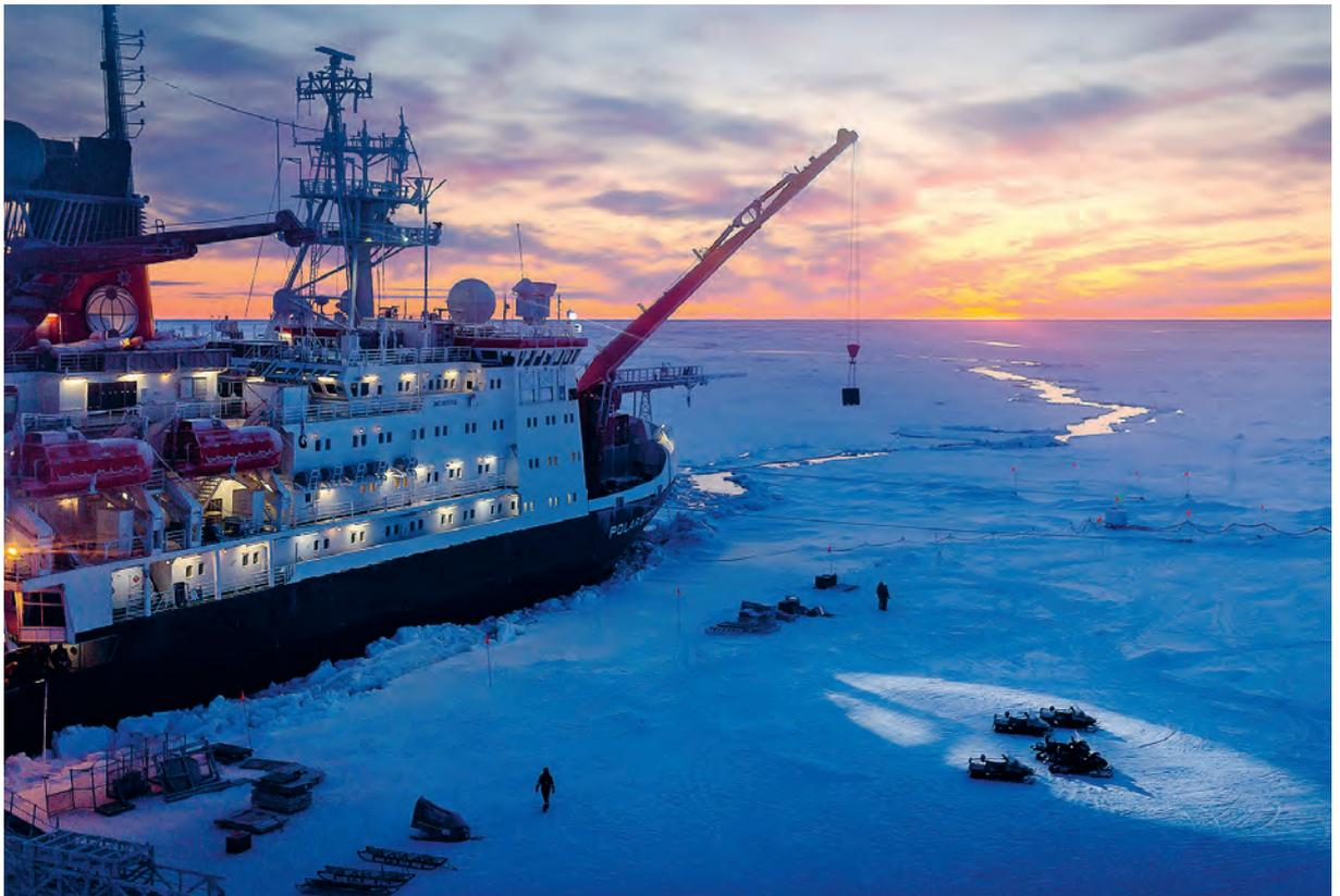
Auch während das Forschungsschiff im Eis eingeschlossen war, mussten die Schiffsmotoren permanent laufen – für Heizung, Licht und Küche, aber auch den Betrieb der wissenschaftlichen Messgeräte.
