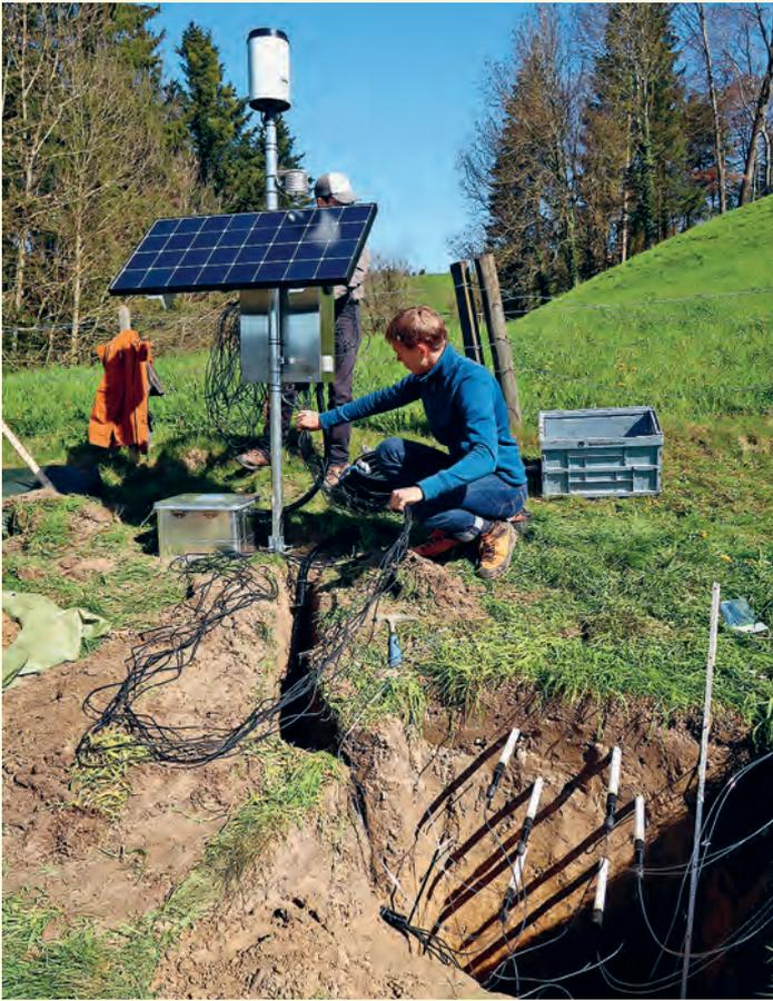
Installation einer Bodenfeuchte-Messstation bei Ranflüh (BE): Forschende verkabeln die Sensoren, die im Bodenprofil stecken, mit dem Datenlogger.
