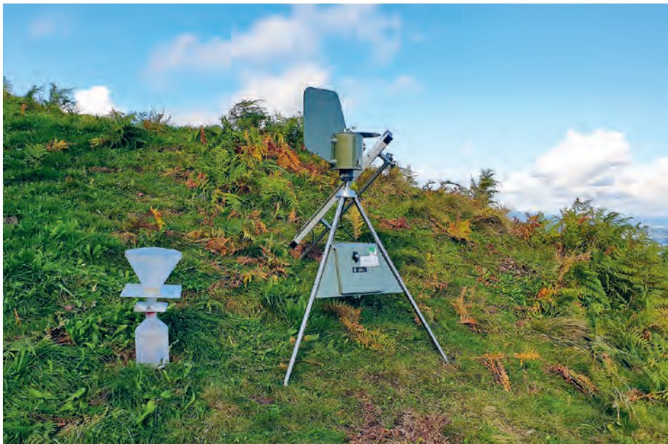
Mit Sporenfallen (im Bild links eine passive, rechts eine aktive) «fangen» die Forschenden Pilzsporen aus der Luft ein. Im Labor untersuchen sie dann das darin enthaltene Erbgut.
