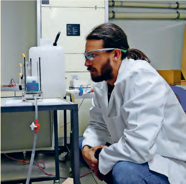
Der Laboraufbau, mit dem Doktorand Michael Lombardo untersucht, wann sich am Übergang vom Schnee zum Boden Wasser sammelt. Der Schnee befindet sich über einer Schicht aus Sand, die den Boden simuliert.
