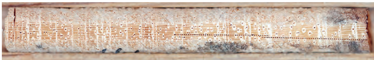
Holz eines Jatobá-Baums aus Costa Rica: Gut sichtbar sind helle Linien und Poren sowie die in einer Linie aufgereihten Brennlöcher des Laserablationsgeräts, deren Durchmesser je 0,1 Millimeter beträgt.
