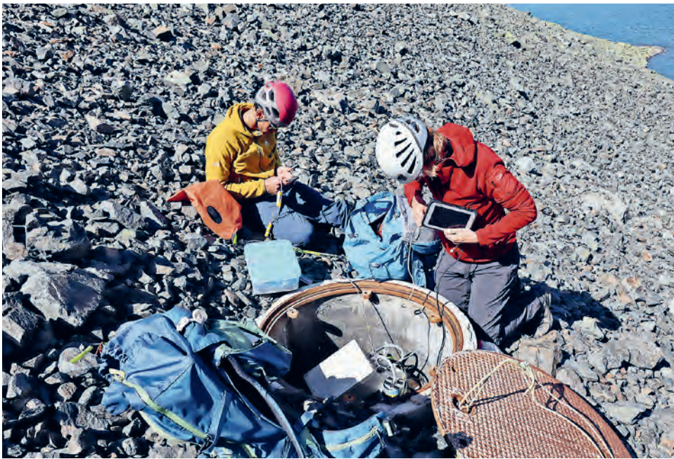
In über dreissig Bohrlöchern in den Schweizer Alpen messen die Forschenden die Temperaturen im Gebirgsboden.
